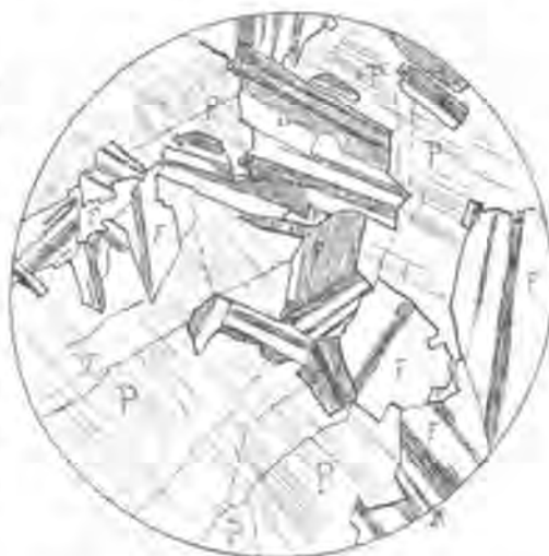
Fig. 7. — Diabase ophitique. Coupe n° 5087. Chambre claire. Lumière naturelle, les feldspaths en lumière polarisée. — P = Pyroxène. — F = Feldspaths.
