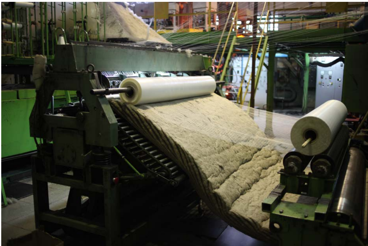
Un des nombreux aspects du basalte converti en isolant à l'usine "Tizol" de Nizhnyaya Tura. Photo ©2014 Pierre Perroud.
