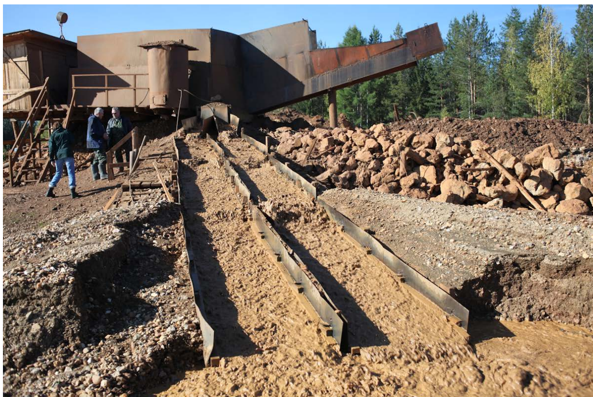
Travaux de staratélis (Au, Pt, Ir, Os, etc.) sur l'Iss. La terre vient par camions d'une région karstique où le Pt a été piégé. Photo ©2014 Pierre Perroud.
